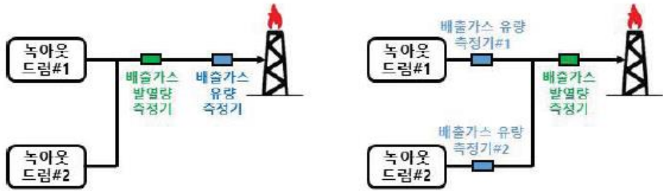
[ 배관 병합시 측정기 설치방법 #1 ]
